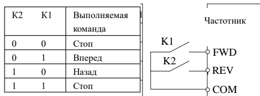
Рис.6-13 Двухпроводной режим управления 1
