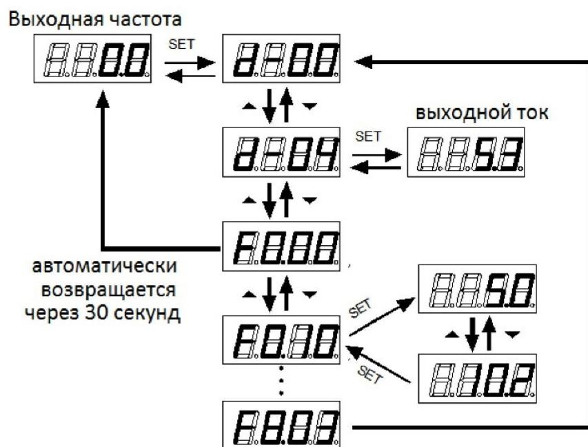
После установки параметра возвращаемся в мониторинг частоты:
