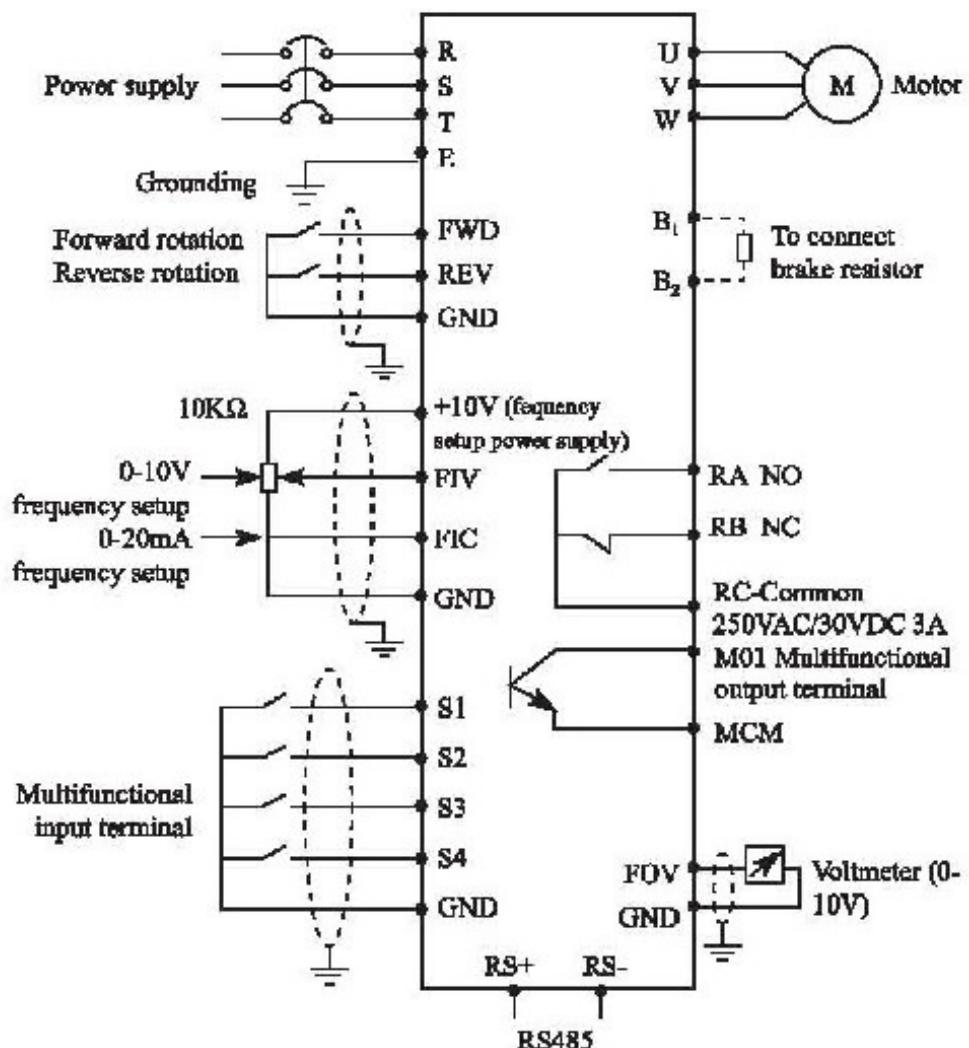
4-2-2 Клеммы терминала управления.
