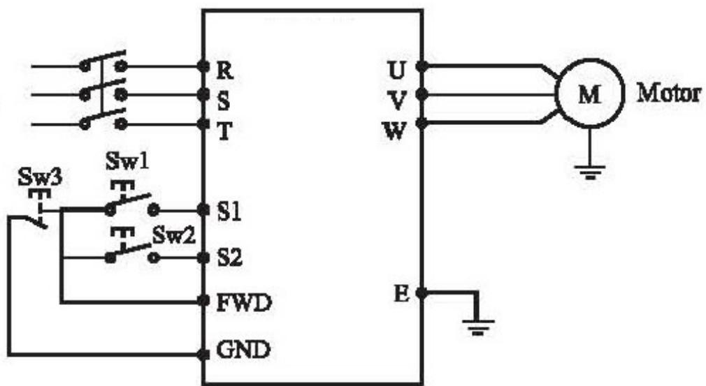
В качестве входов для внешнего сигнала здесь используются Sw1, Sw2, и Sw3. Контакт Sw3 нормально замкнутый.
