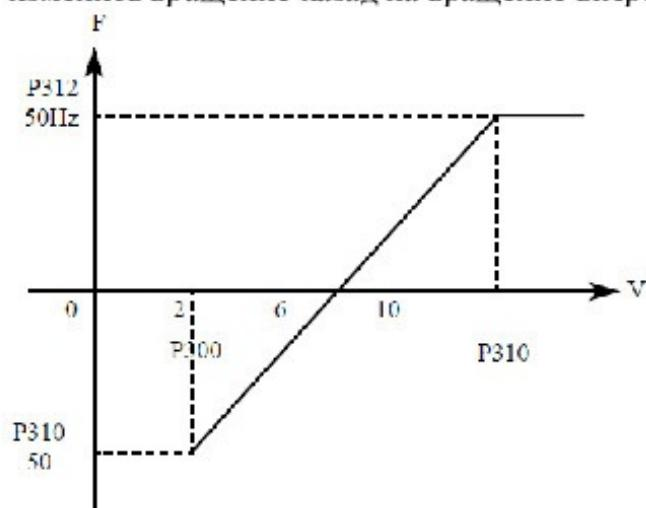
Примечание: Р300=2, минимальное входное напряжение на входе AV: 2V (сигнал с напряжением ниже 2V считается равным нулю);
