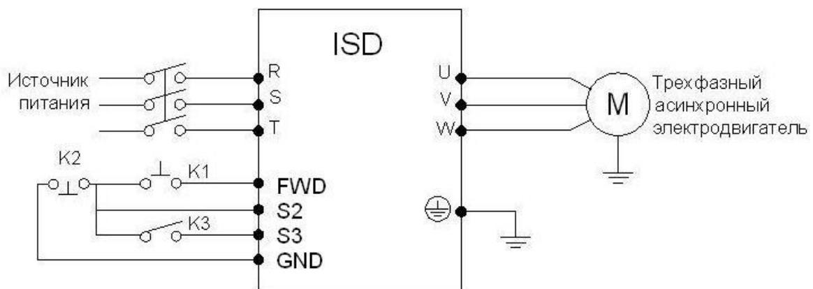
(2) Настройка параметра PF33 определяющего направления вращения
