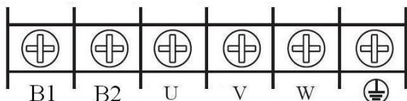
Момент затяжки винтов на силовых клеммах преобразователя 1,4 Н·м.
